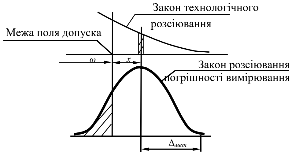
Рисунок 26 – Взаємодія похибки вимірювання і технологічного розсіювання розмірів
